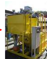
ネオナイトクリーナーにて自動的に排水処理
