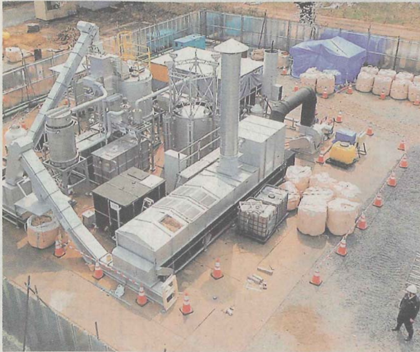
ネオナイトが実証実験のため福島県内に設置したガス化発電システム＝ネオナイト提供
